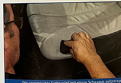
Die angemischte Farbe wird mit einem Schwamm aufgetragen.
